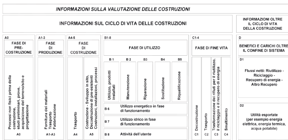
Figura 1 - Fasi del ciclo di vita di un'opera civile secondo norma UNI EN 15643
